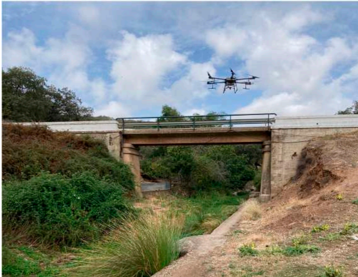
Fig. 31. Ensayo de campo para evaluar las condiciones operativas de un dron con depósito de biocida hasta 30 litros (7 de septiembre 2023, Arroyomolinos de León).
