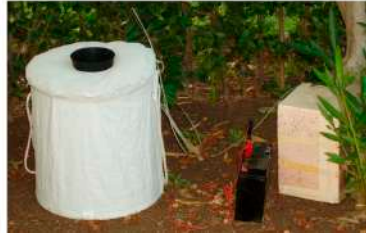
Fig. 33. Tipos de trampas para la captura de mosquitos; de izquierda a derecha: tipo CDC; tipo BG; y BG Counter; todas suplementadas con CO 2 .
